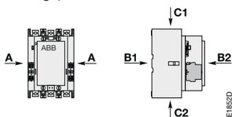
Halbwellen-Sinusschock 30 ms lang: keine Änderung der Kontaktposition
