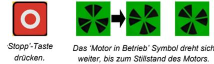
**5. Die Motorrichtung ändern:** Bei stillstehendem Antrieb drücken Sie gleichzeitig die **'Stopp'**-Taste und entweder die **'Nach oben'** (Vorwärts) oder **'Nach unten'** (Rückwärts) Taste.
